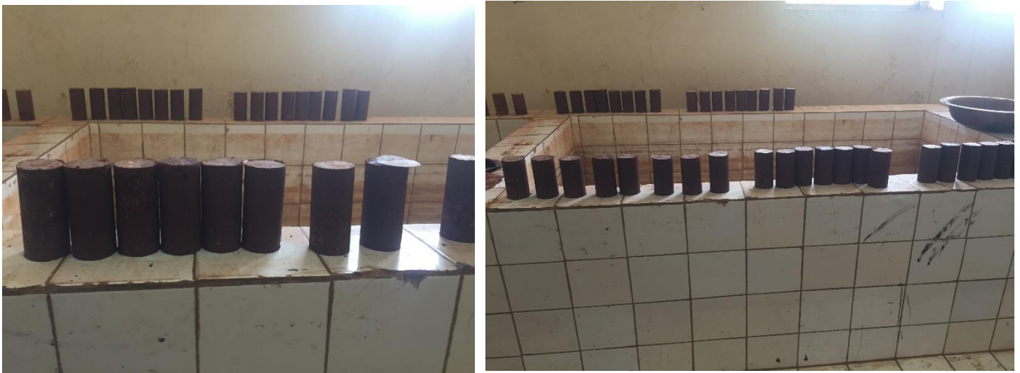
Figure 6 : Echantillons de blocs de terre stabilisée à différents pourcentages de ciment.
