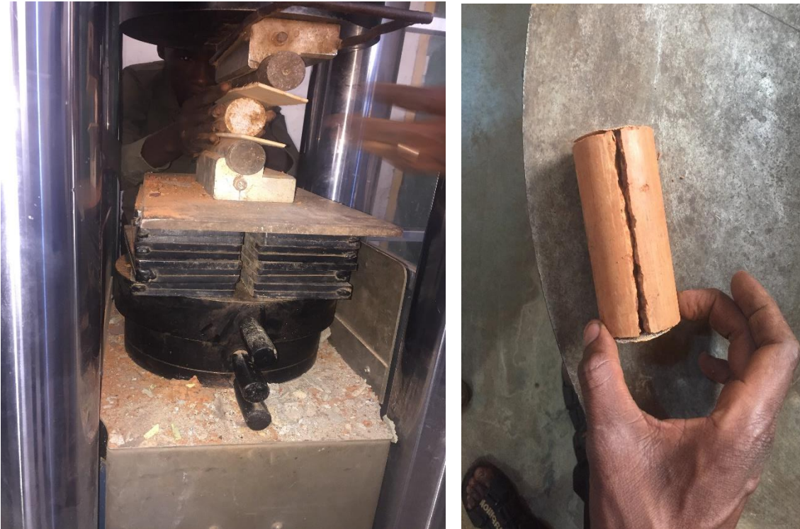
Annexe 2 : Dispositif de l'essai de traction par fendage d'éprouvettes.
