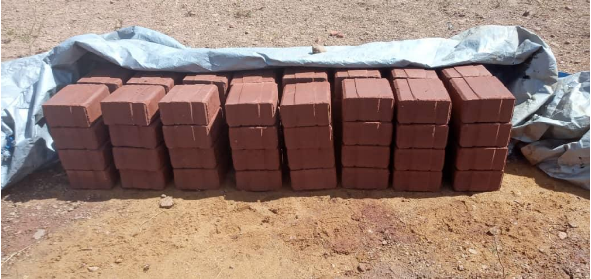
Annexe 4 : Blocs de terre stabilisée produit par la presse HYDRAFORM au CNREX-BTP.
