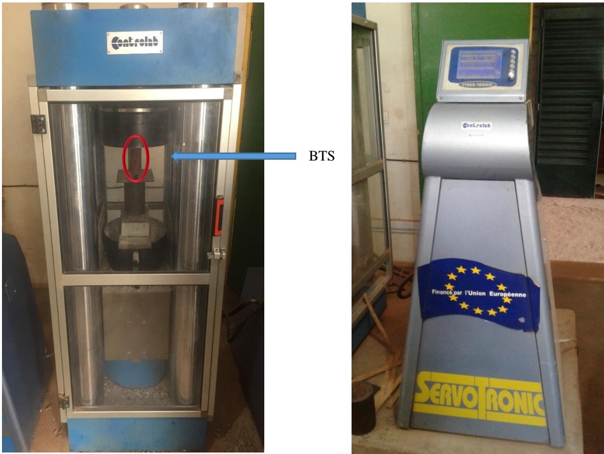
Figure 7 : Ecrasement d'une éprouvette de blocs de terre stabilisée à l'aide de la presse de compression.
