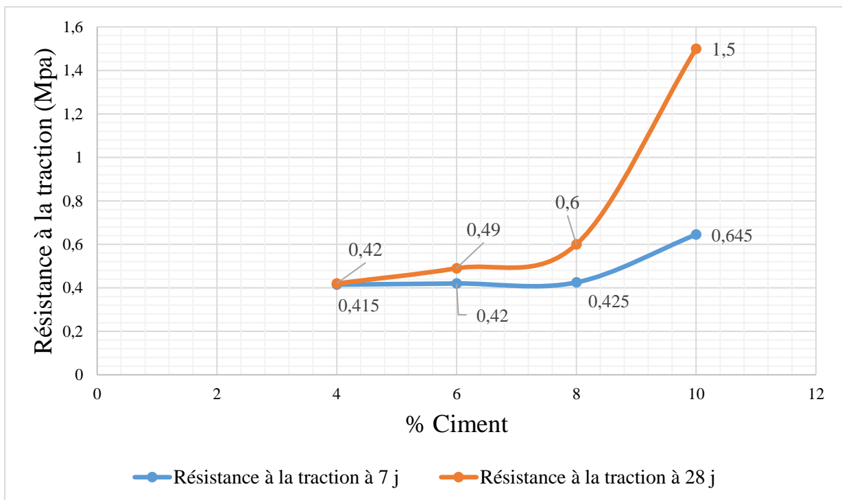
Figure 8 : Variations des résistances à la traction en fonction des pourcentages de ciment et de l'état d'humidité des échantillons.
