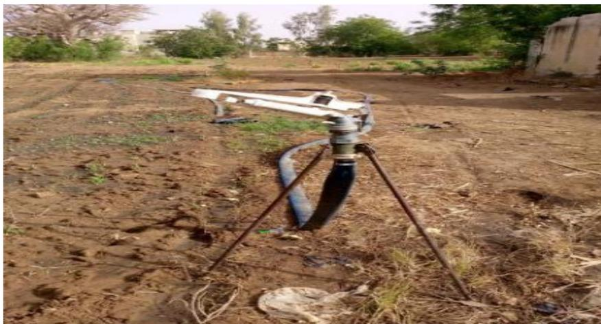
Figure 5 : Dispositif d'aspersion
